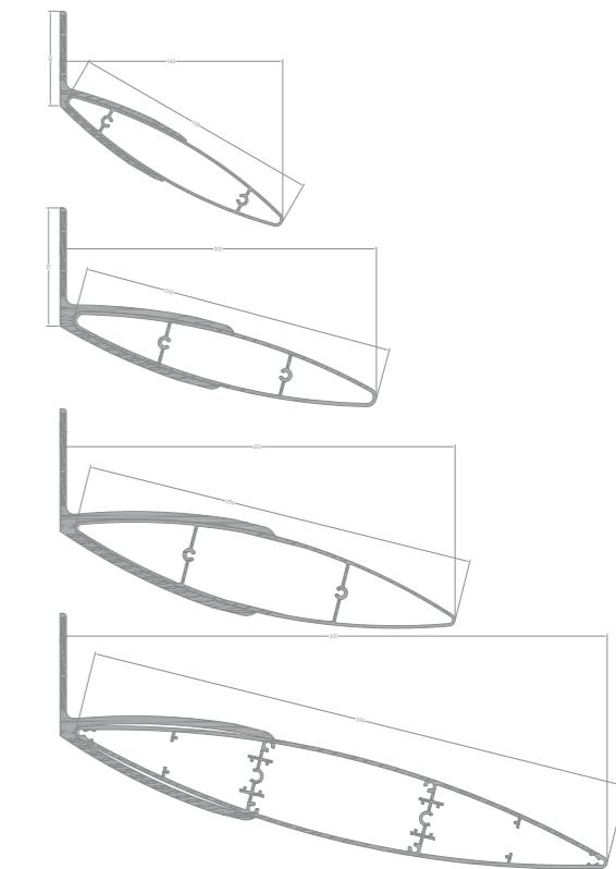
Příkladové rozměry a úhly sklonu slunolamů
