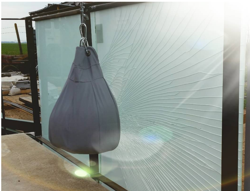
Ukázka, jak vypadá zasklení při normové simulaci pádu člověka na sklo podle ČSN 743305.
